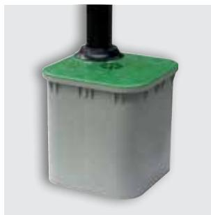
I pozzetti portapalo POLI BOX hanno un cilindro interno per l'inserimento di un palo d'illuminazione Ø 60 mm, sono forniti con 4 viti in acciaio INOX e 1 flangia di finitura.
